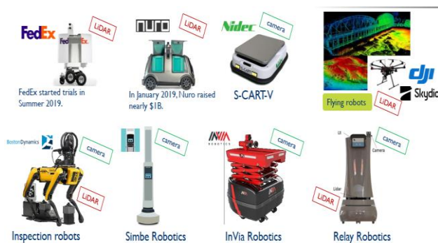
图表 14 AGV 机器人主要适用激光雷达和视觉传感技术
