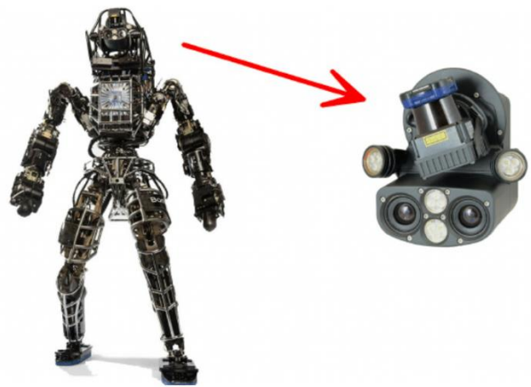
图表 24 配备旋转激光雷达扫描仪和立体摄像头的波士顿动力 Atlas 机器人
