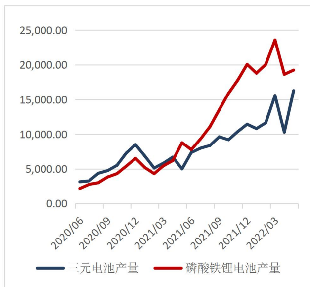
图 22：动力电池分种类产量（兆瓦时）
