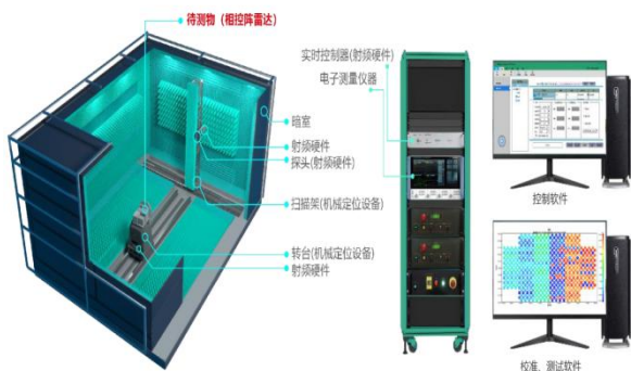
图 42: 相控阵校准测试系统组成
