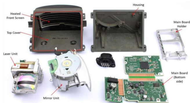
图表 101：Valeo SCALA1 拆解主要零部件
