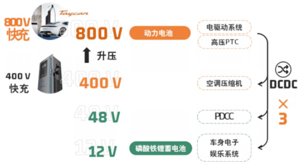
图：Taycan内部电压转化器应用
