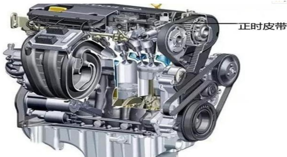
图4：同步正时带用于同步汽车引擎中各缸体的进排气时间
