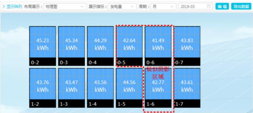
图：微逆可精准定位发电量受损组件
