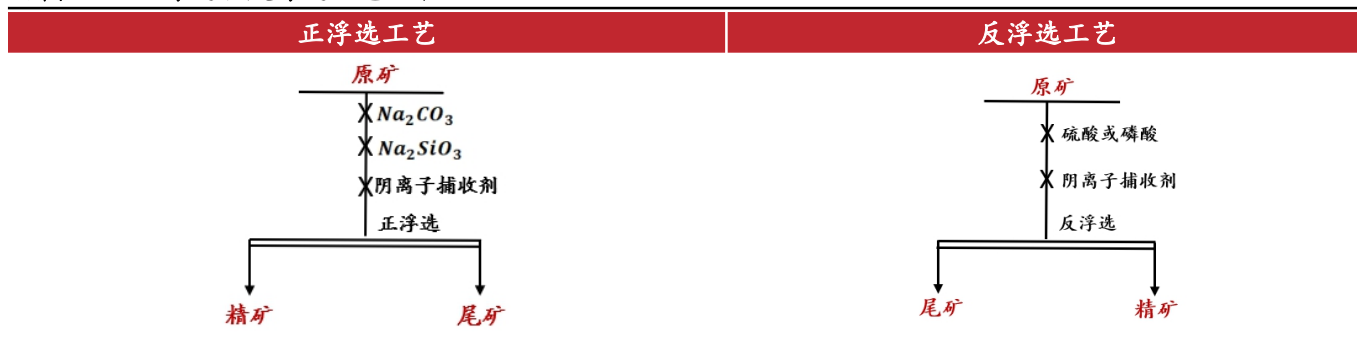
图表 8. 正浮选、反浮选工艺流程
