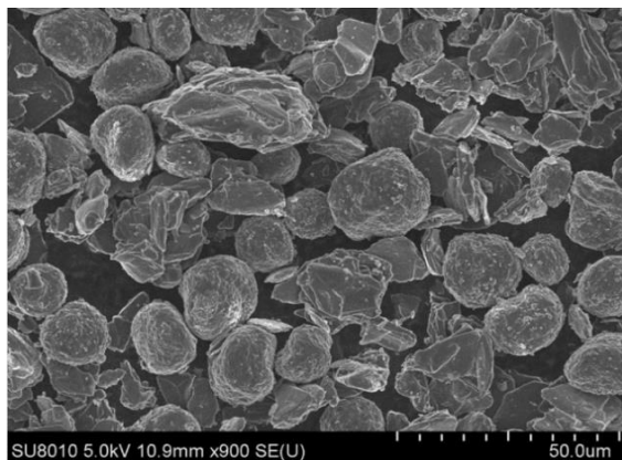
图 5：硅氧负极材料微观结构
