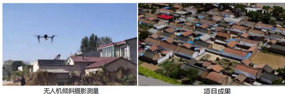
图 39: 华测导航航测无人机在房地一体项目中的应用
