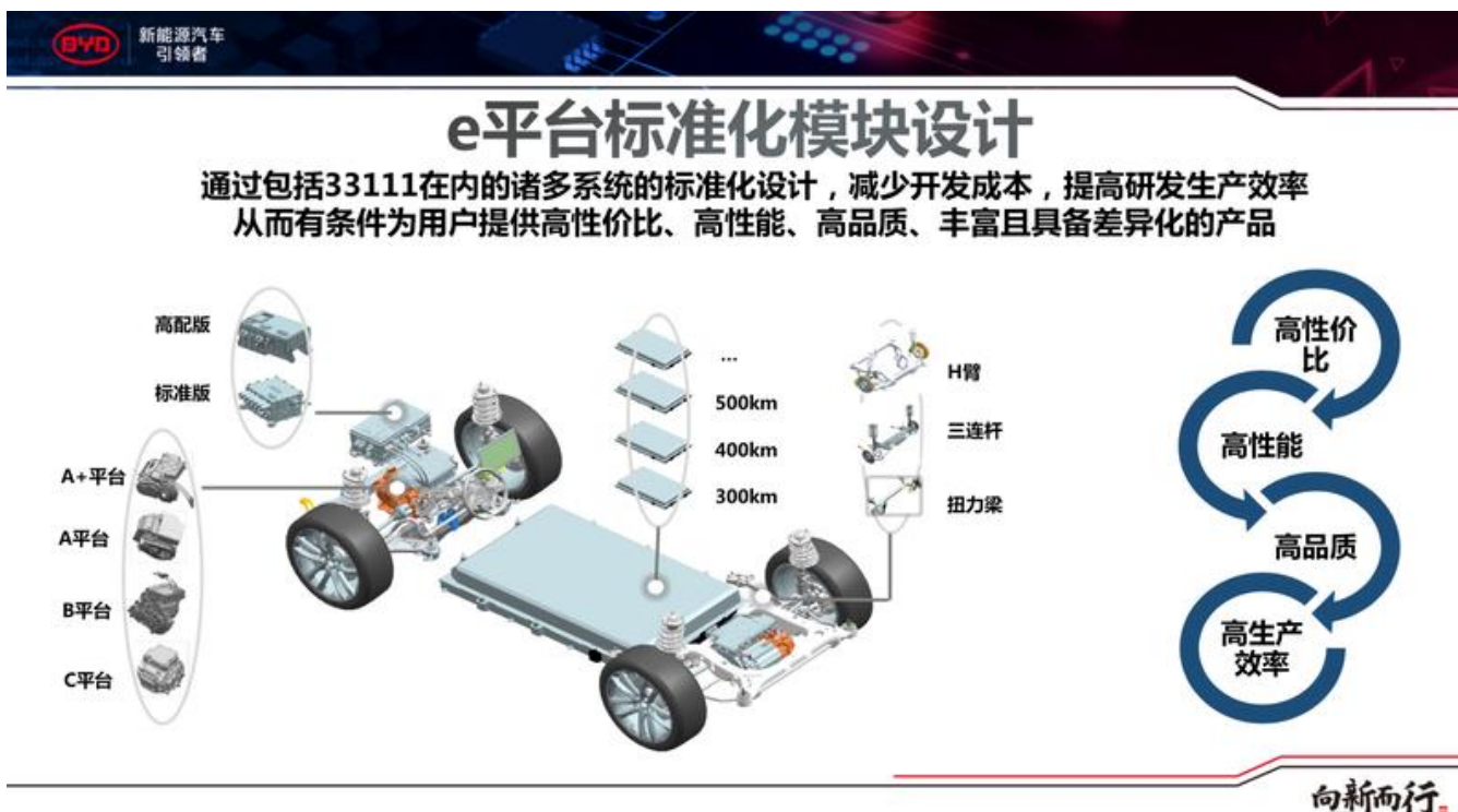
图：比亚迪e平台标准化模块设计
