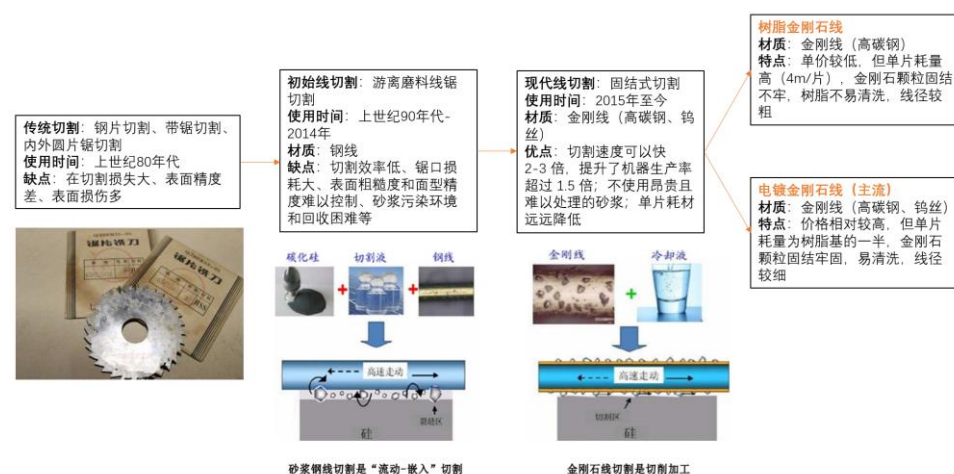
图 24：金刚线切割为行业主流硅片切割方式
