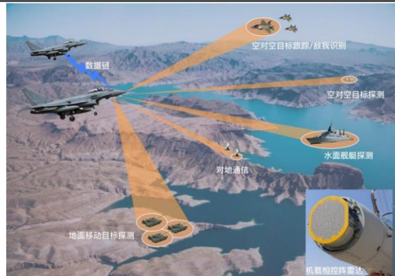
图 14：机载数字相控阵雷达工作示意图
