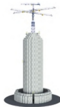
图32：Energy Vault 重力储能概念图
