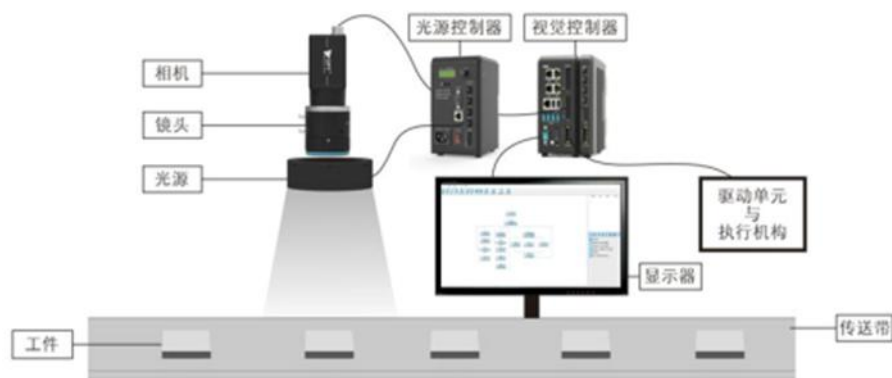
图 4：机器视觉系统的构成
