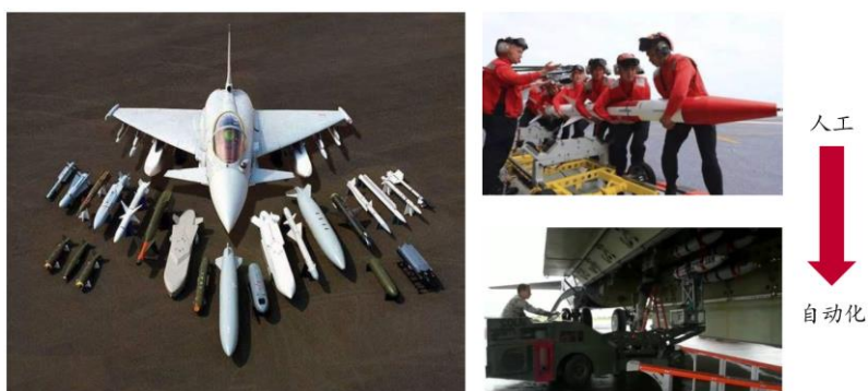
图表 14：飞机外挂载荷多样化对自动化挂载提出了更高的要求
