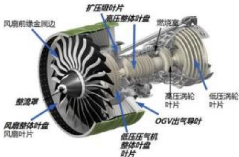
航空发动机叶片示意图
