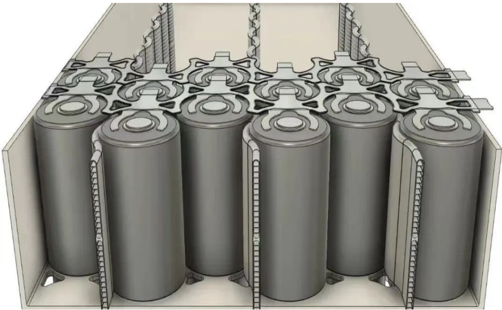
图15：4680电池包电芯排列设计图
