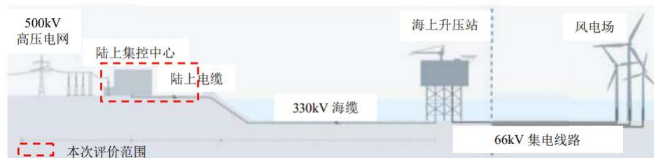
图表 43：青洲六海上风电场海缆集中送出工程输电结构示意图
