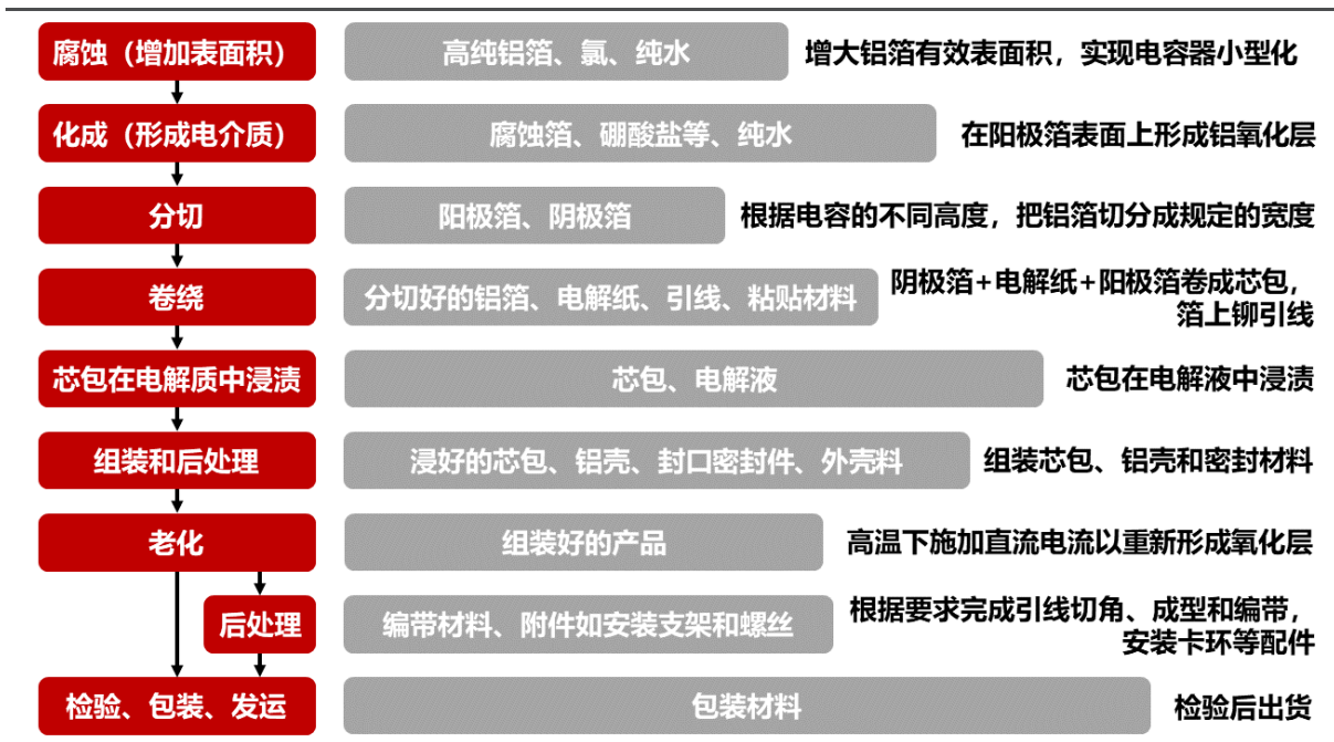
图 21：铝电解电容器制造流程
