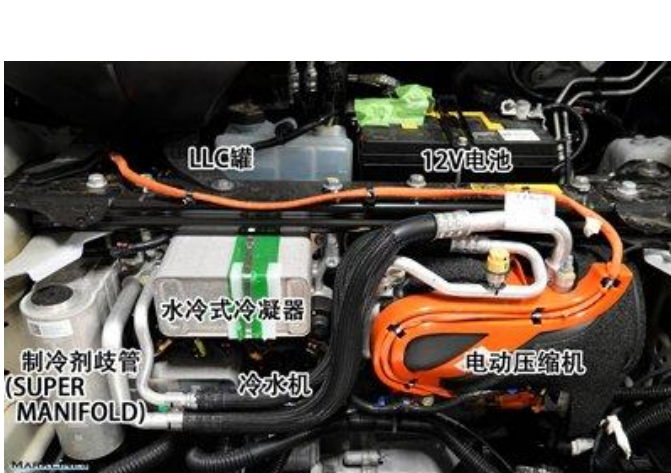
图表 36: Model Y 前方发动机罩内的热泵系统
