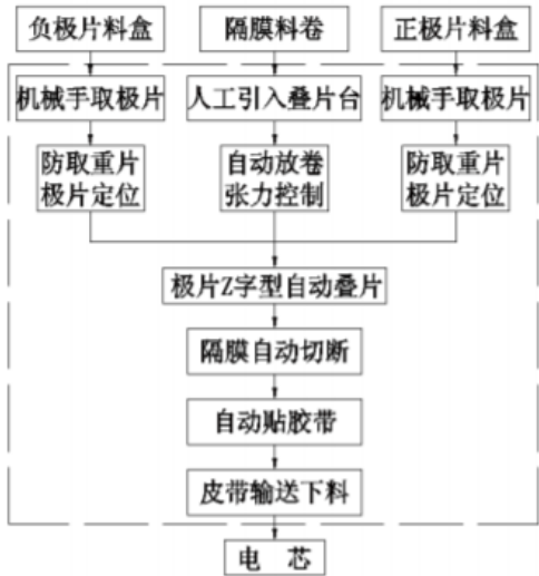
图：叠片机工作流程
