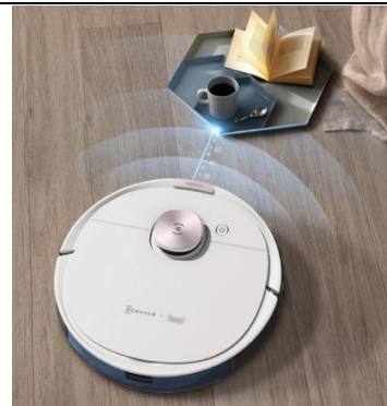
图27：扫地机器人使用摄像头进行感知避障
