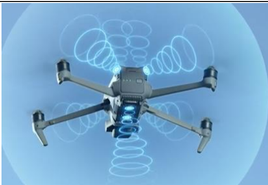
图26：无人机使用摄像头进行感知避障
