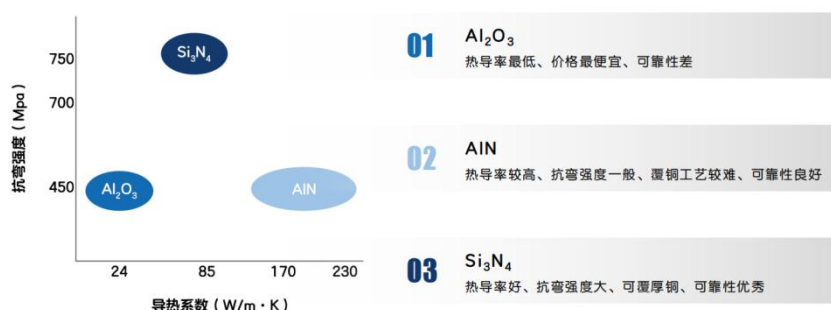
图 21：陶瓷基板主要材质性能比较
