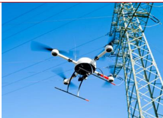
图表 34: 无人机电力巡检
