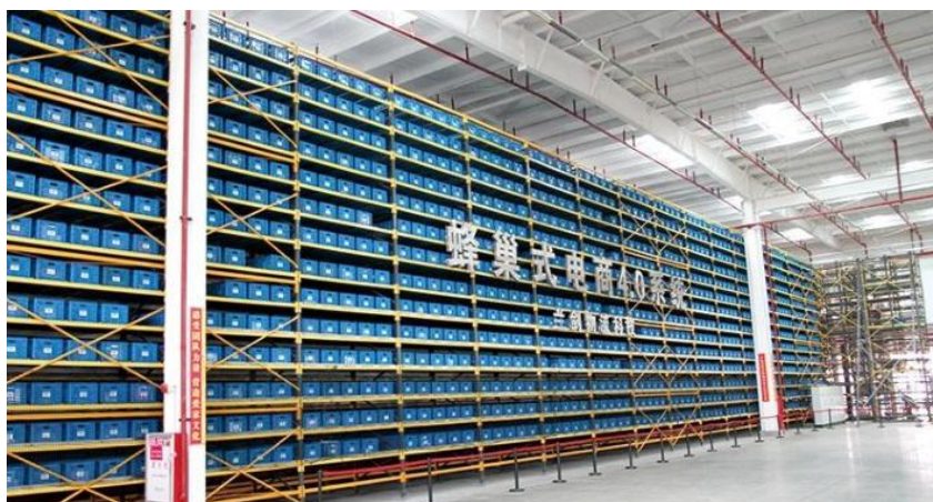
图 22：公司核心产品料箱级密集仓储拣选（立体货到人）一体化系统
