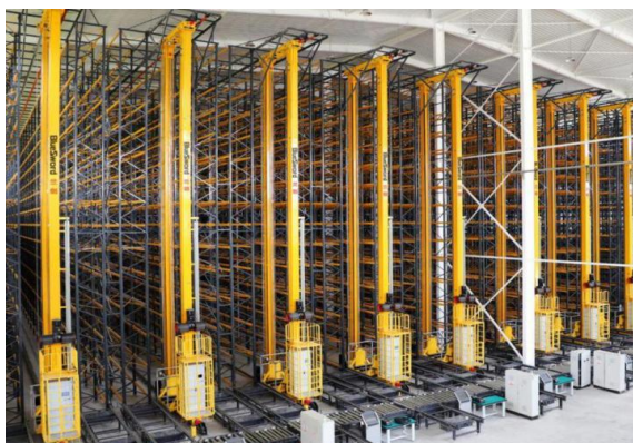
图 20：托盘级系统中的托盘堆垛机
