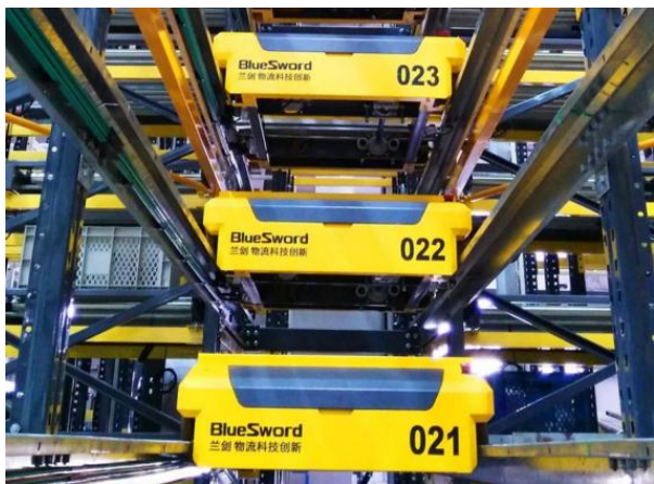
图 23：料箱级系统中的穿梭车
