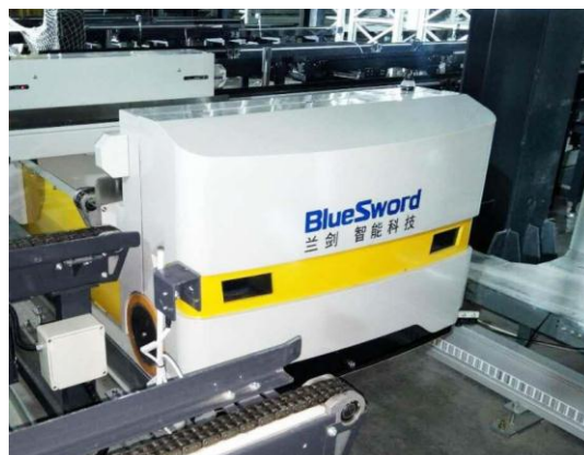
图 21：托盘级系统中的托盘有轨搬运车 RGV
