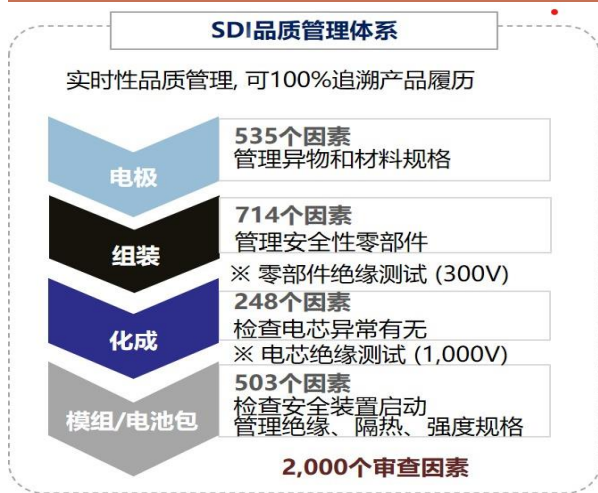
图 4：锂电池的长流程制造管理体系复杂
