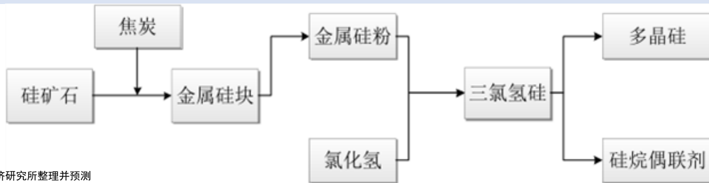
图：改良西门子法生产多晶硅工艺流程
