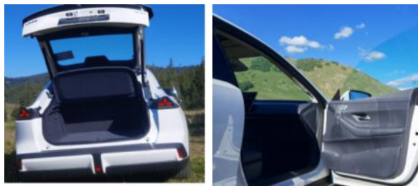
图11：深蓝 SL03 无框车门与掀背式尾门
