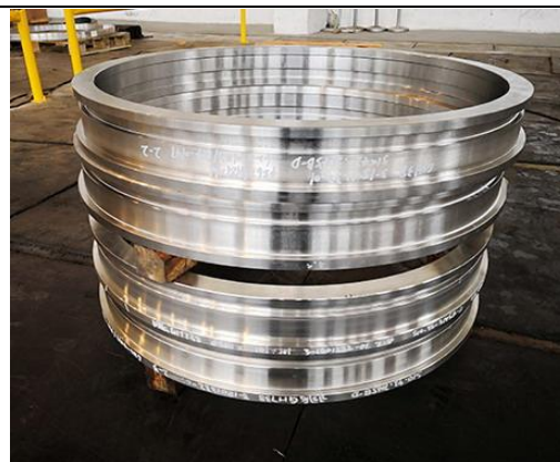
图 30：派克新材某型航空锻件产品
