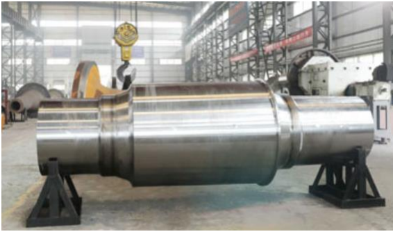
图 39：水泥矿山自由锻件示意图
