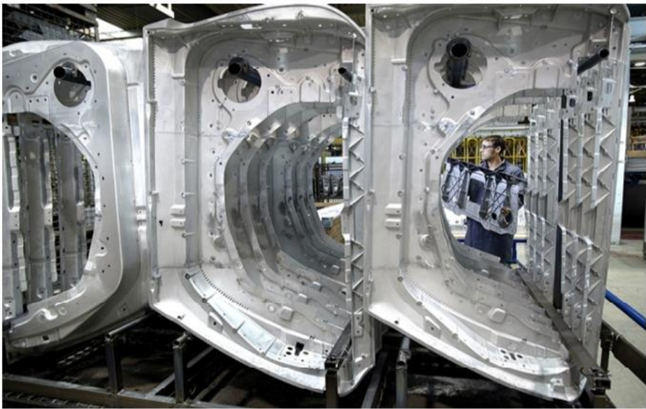
图14：美国铝业公司560合金用于日产GT-R车门板
