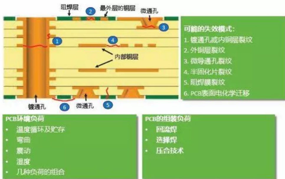
图 45：PCB 的常见环境负荷和组装负荷及其导致的可能失效模式
