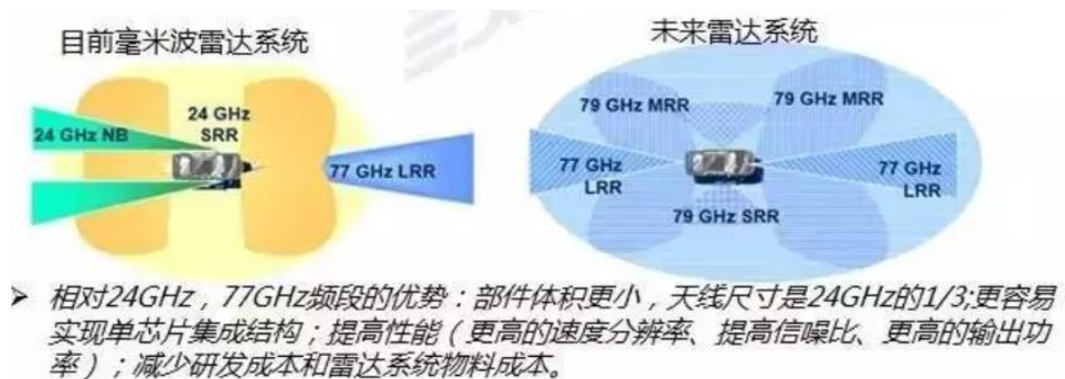
图 17：77GHz 毫米波雷达具备优势
