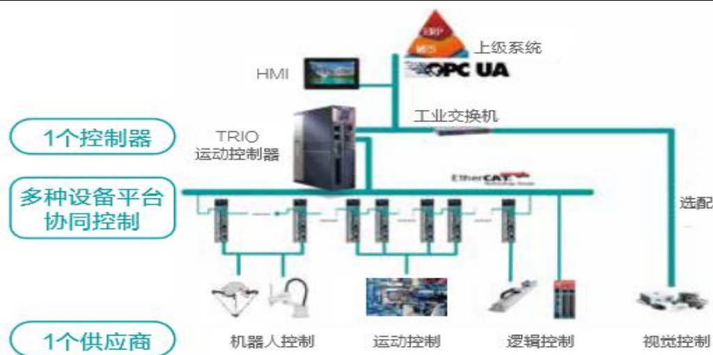
图41：埃斯顿全新的智能控制单元解决方案示意图
