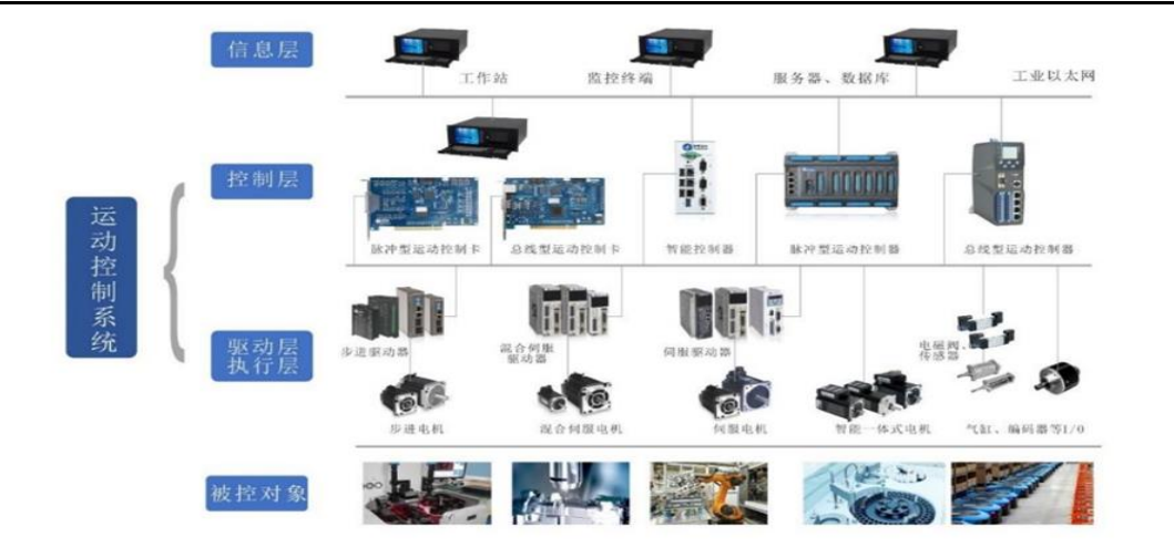
图19：运动控制系统应用原理
