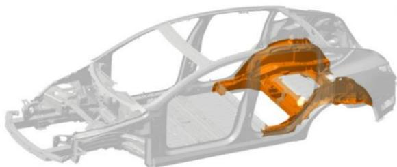
22Q1，特斯拉Austin工厂生产Model Y前舱和后地板均采用一体化压铸
