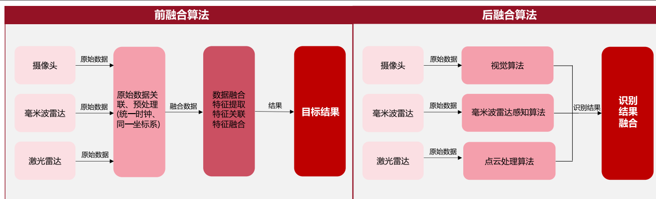
图63：前融合算法和后融合算法原理
