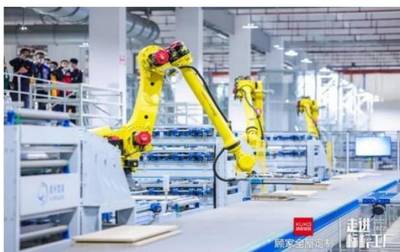
机械手臂 ——智能分拣+智能包装，自动读取板件二维码，杜绝板件少、漏、缺及窜货等
