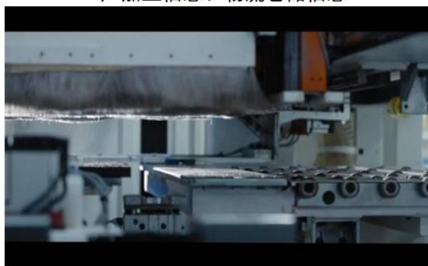
条形码管理系统 ——每块板材都有专属二维码，设备可识别每块板的订单信息、客户信息、生产加工信息、物流仓储信息
