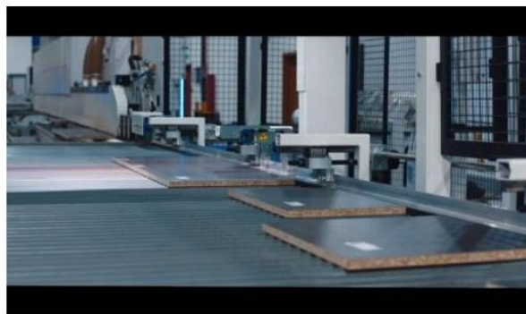
条形码管理系统 ——每块板材都有专属二维码，设备可识别每块板的订单信息、客户信息、生产加工信息、物流仓储信息
