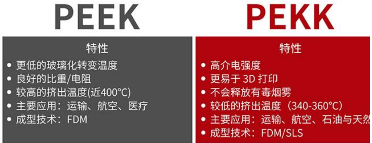
图 42：PEEK 与 PEKK 特性对比
