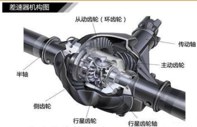
图 13：差速器机构图
