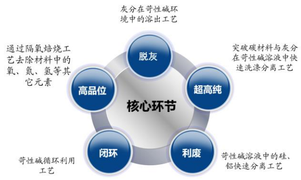
图28：核心环节是化学脱灰及隔氧焙烧
