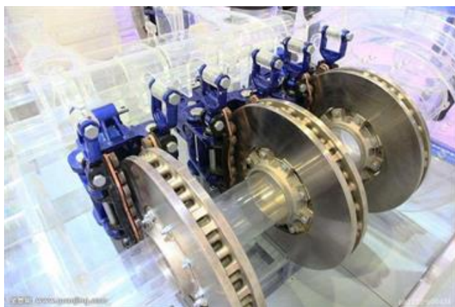
图11：闸片与制动盘组成一对摩擦副（示意图）
