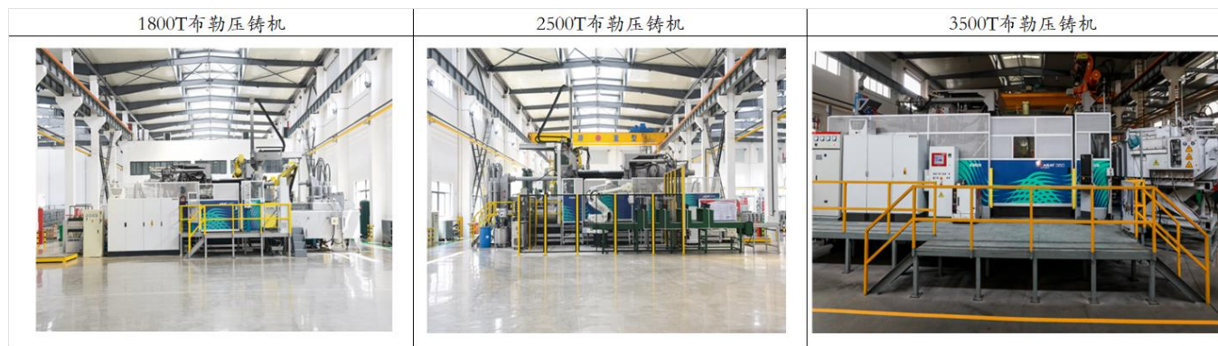
图 41：公司不同吨位的自动化压铸机
