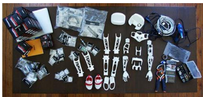
图13：Poppy 机器人主要零部件通过 3D 打印完成
