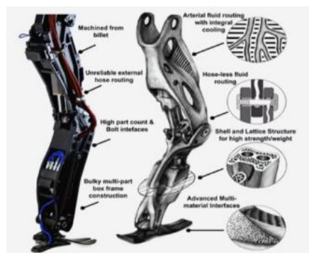
图14：Atlas 机器人的腿部结构
