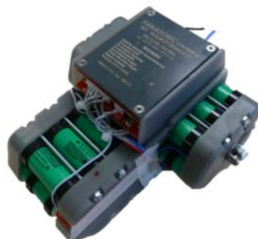
图20：欧洲 iCub 机器人使用的锂电池组
