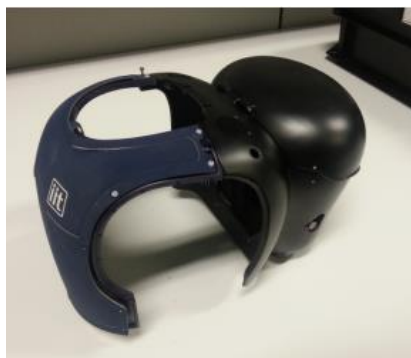
图19：欧洲 iCub 机器人的电池背包
