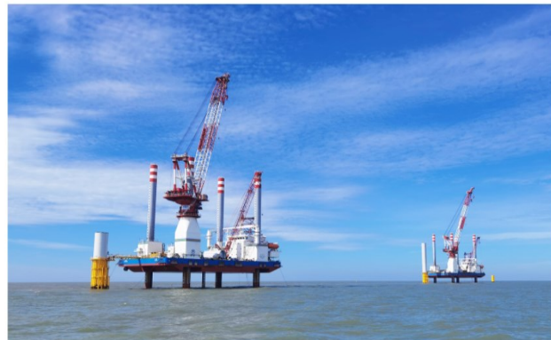
图20：中天 7、中天 8 自升式风电安装平台
