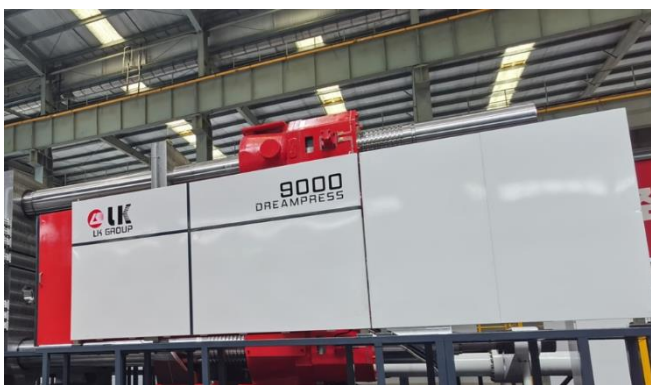
图18：9000T 超大型压铸机
