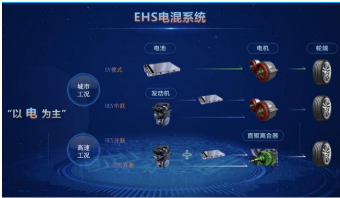
图表 34: EHS 电混系统工作原理
