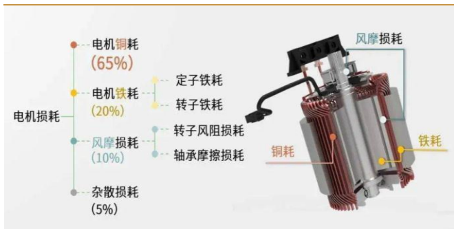
图 10：永磁电机绕组铜耗占比 65%
