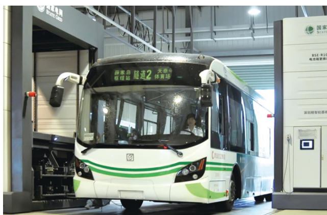
图19：深圳精智换电设备早期已在电动公交上实现应用
