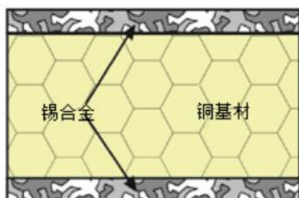
图5：光伏焊带横截面
