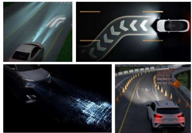
图23: DLP 技术使前照灯具备“投影”能力
